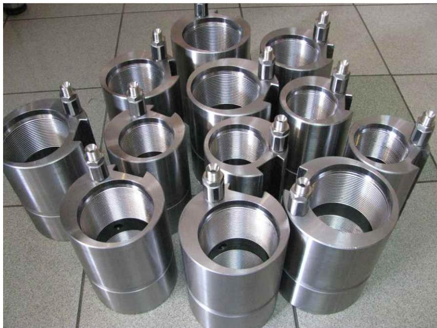
**Вводная муфта предназначена для подачи химического реагента вовнутрь колонны насосно-компрессорных труб.** Устанавливается в любой интервал скважины. Состоит из эксцентричной муфты и встроенного обратного клапана. Предусмотрен технологический паз для укладки кабеля.
