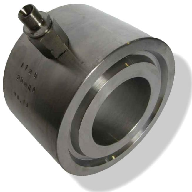
**Устройство ввода входит в состав оборудования для дозированной подачи химического реагента.** Устройство ввода выполняет функцию соединения наземного и скважинного трубопровода, обеспечивая проход линии подачи реагента через устьевую арматуру. Основные типоразмеры – Ду65, Ду80.
